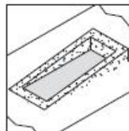
La finestra mod. "C" può essere installata con pendenze a partire da 8°. In caso di tetti piani è possibile installare il modello "C" predisponendo il piano di appoggio con una leggera pendenza.
